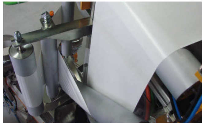
Sauber gewickelte und präzise Filmrollen dank Wendestangenabzug.
