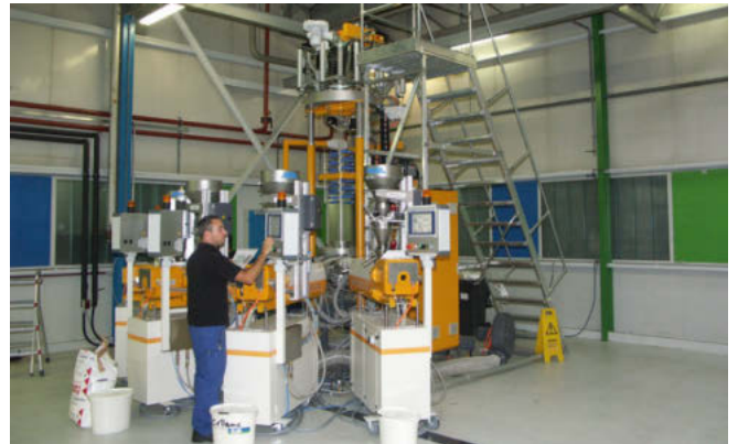
Mit der computergesteuerten Pilotanlage können qualitativ hochwertige Klebefilme im Labormassstab hergestellt werden.
