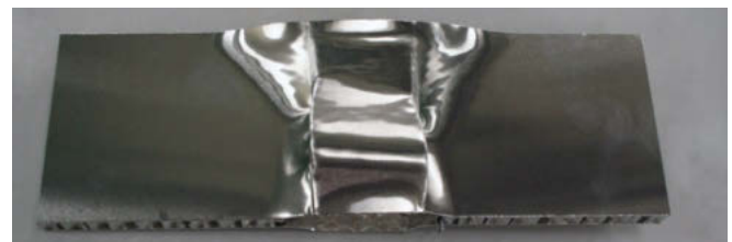
Bild 10: Kraftverlauf bei Schlagfestigkeitstests und entsprechender Prüfkörper nach dem Test.
